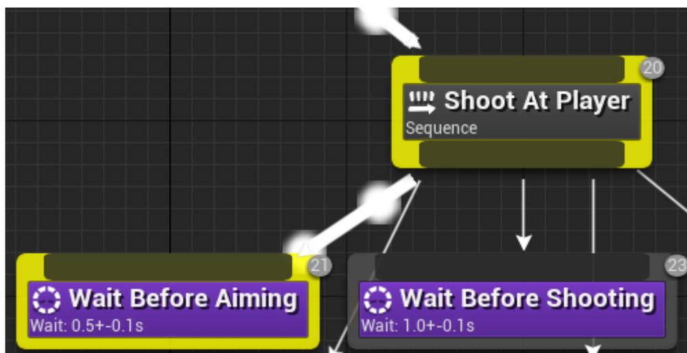
**Abbildung 32:** Visualisierung des ausgeführten Behavior Trees, wobei Nodes, welche gelb markiert sind, durch die KI ausgeführt werden.
