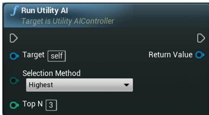
**Abbildung 19:** Abbildung des Blueprint-Nodes *RunUtilityAI*, welcher durch die gleichnamige Funktion in C++ generiert wird. Dadurch können Parameter zur Selektionsmethode konfiguriert werden.
