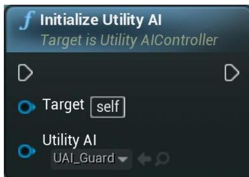
**Abbildung 18:** Darstellung des *InitializeUtilityAI* Blueprint-Nodes, der die Action-Nodes des Utility AI Graphen speichert und ein Graph-Asset als Übergabeparameter benötigt.
